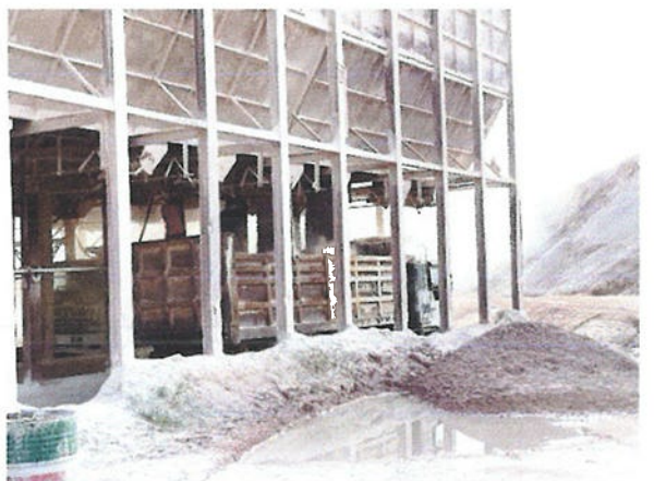
รูปที่ 18 การออกแบบยังเก็บหิน เพื่อลดการฟุ้ง กระจายของฝุ่นหินจากปลายสายพาน
