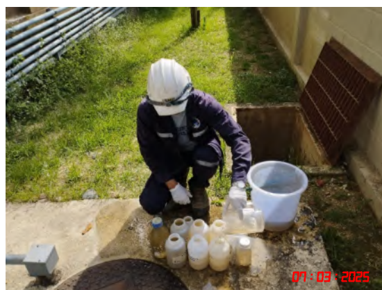
บ่อตรวจคุณภาพน้ำหลังออกจาก ระบบบำบัดน้ำเสียโครงการ ชุดที่ 2
