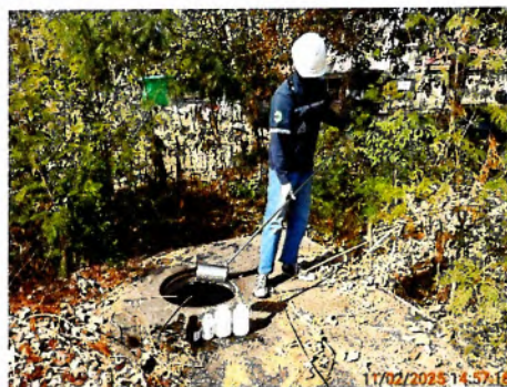
บ่อพักหลังผ่านระบบบำบัดน้ำเสียรวม
