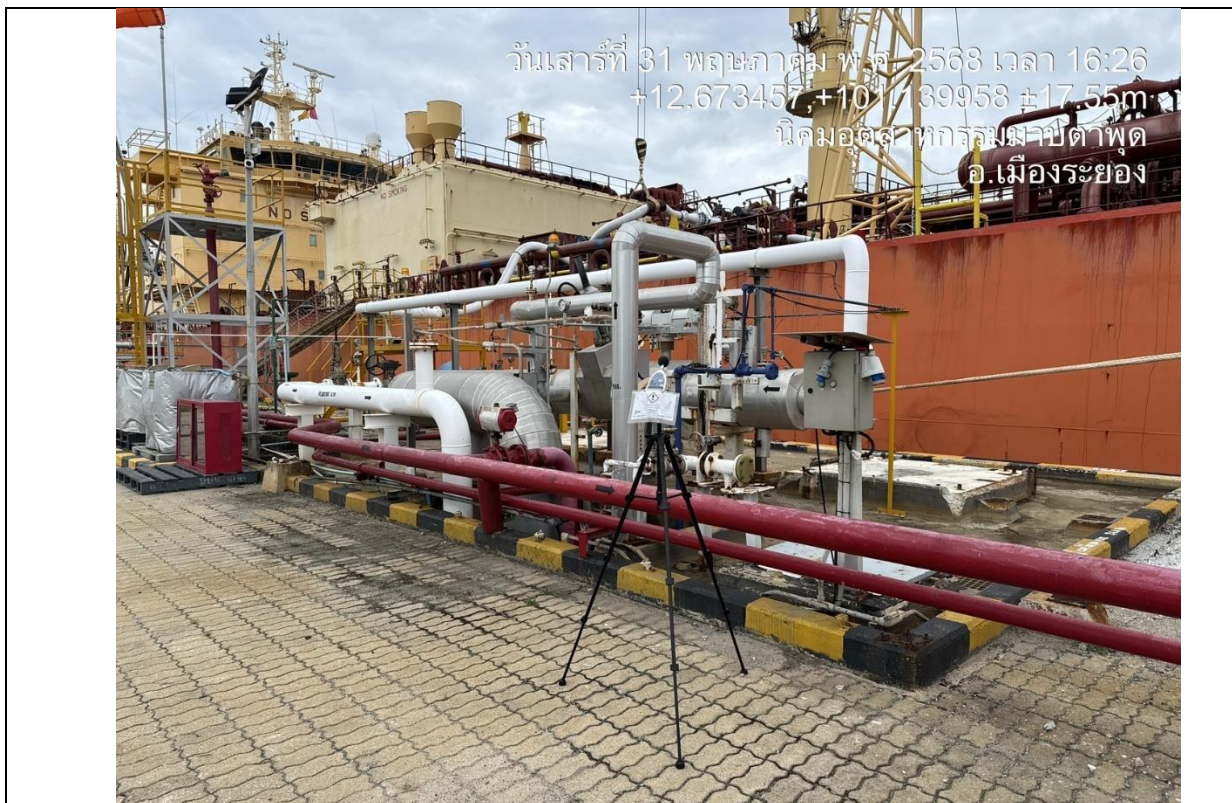
รูปที่ 3-40 การตรวจวัดระดับเสียงบริเวณพื้นที่การทำงานบริเวณหน้าท่า
