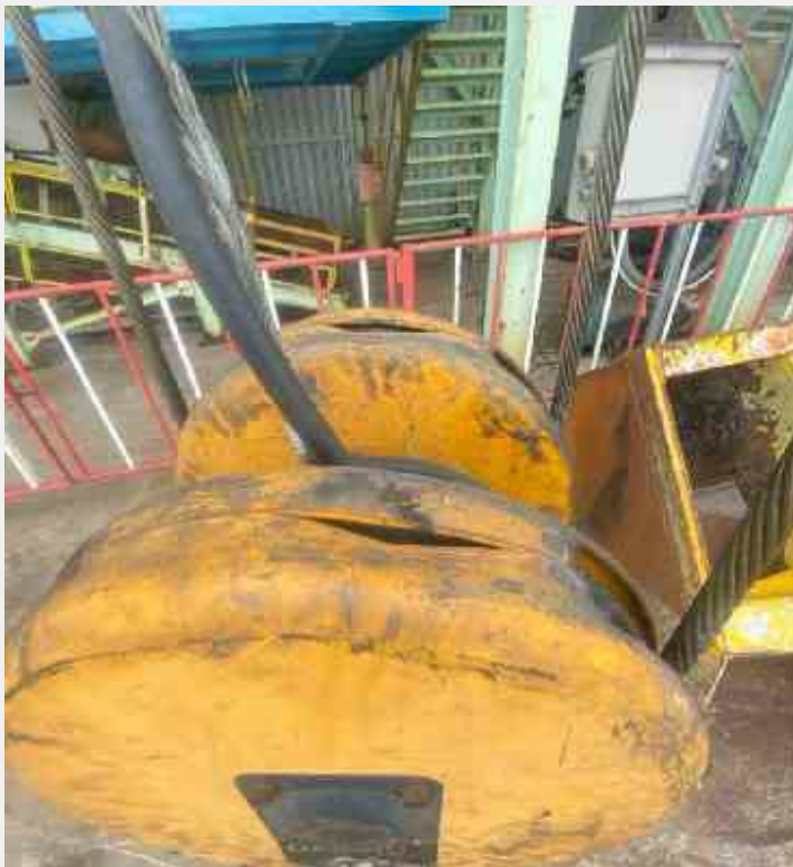
River side, Hook block structure and markings, Sheaves เสี่ยงหาย / ลิกหรือ
