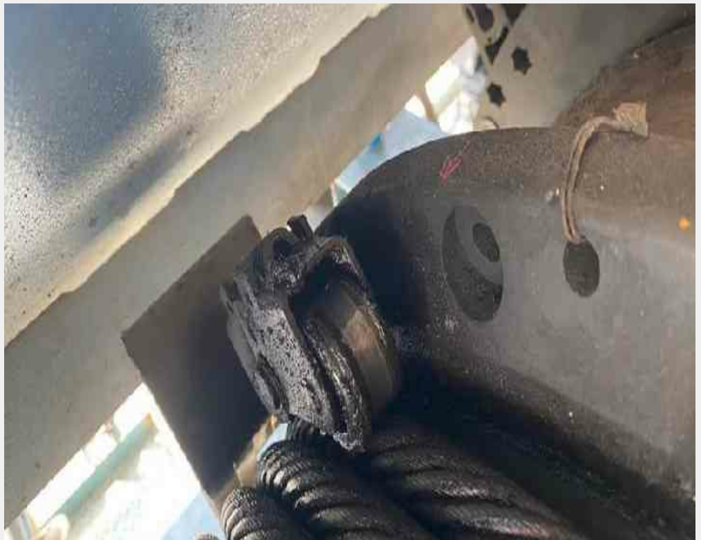
River side, Rope guide, ลีกรอ/ชำรุด
