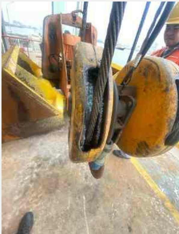
River side, Hook block structure and markings, Sheaves เลี้ยวหาย / ลึกหรือ
