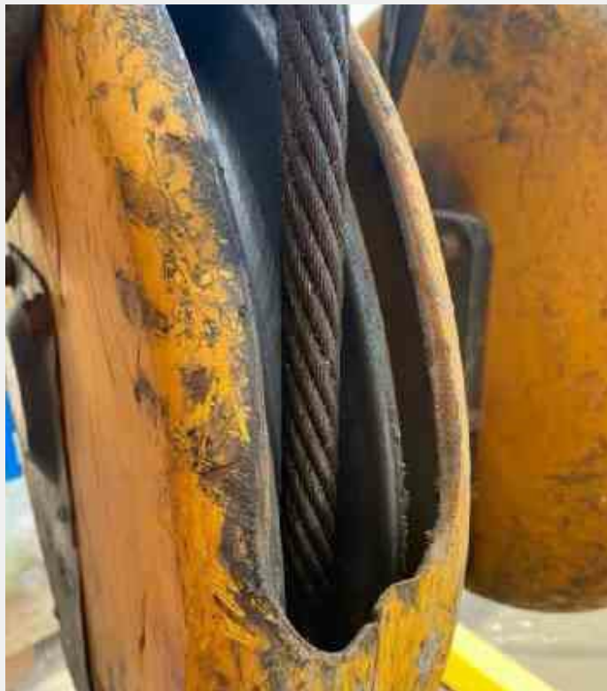
River side, Hook block structure and markings, Sheaves เสี่ยงหาย / ลิกหรือ
