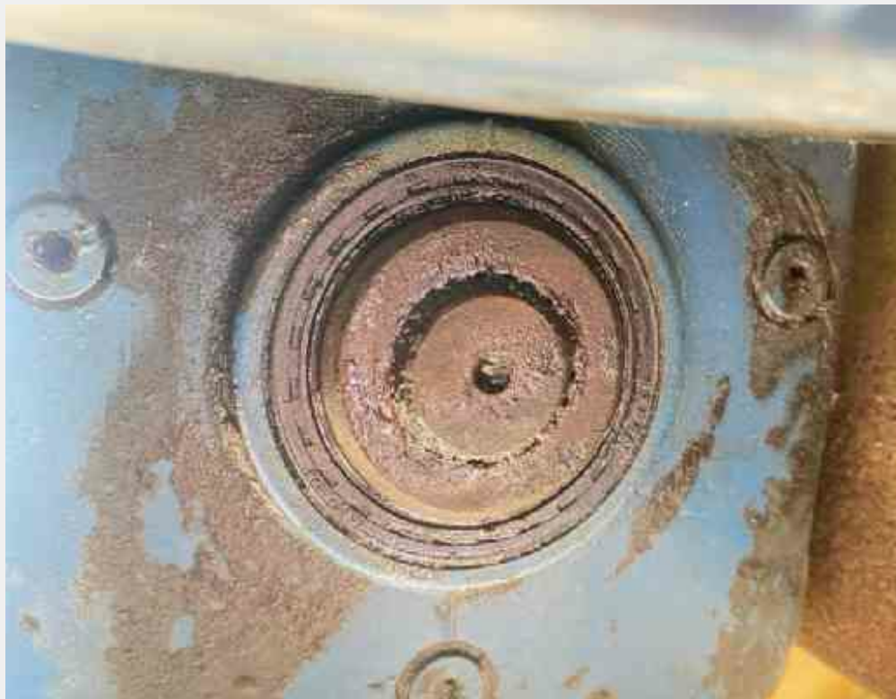
River side, เกียร์ชุดวิ่งทางยาว, การรั่วไหลที่ซีลเพลา
