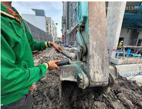
รูปที่ 17 เจ้าหน้าที่หยดน้ำมันหล่อลื่นเครื่องยนต์
