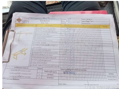
รูปที่ 40 ตรวจสอบสภาพการใช้งานเกี่ยวกับระบบเบรก Limit Switch สลิง เชือก อุปกรณ์การยก
