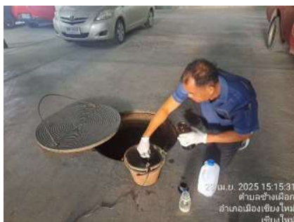
จุดเก็บน้ำทั้งก่อนเข้าระบบบำบัดน้ำเสีย
