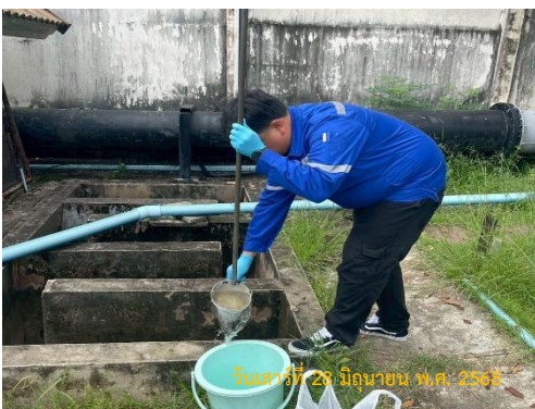
การเก็บตัวอย่างน้ำทิ้งหลังการบำบัด บริเวณจุดก่อนปล่อยออกคลองคลองแม่จันทร์
