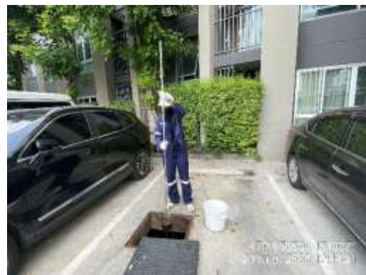
รูปที่ 10 การเก็บตัวอย่างน้ำทิ้งของระบบบำบัดของโครงการ
