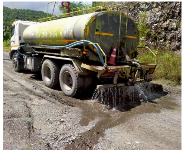
รูปที่ 2-15 การฉีดพรมน้ำบริเวณเส้นทางภายในพื้นที่หน้าเหมืองและเส้นทางขนส่งแร่ของโครงการ
