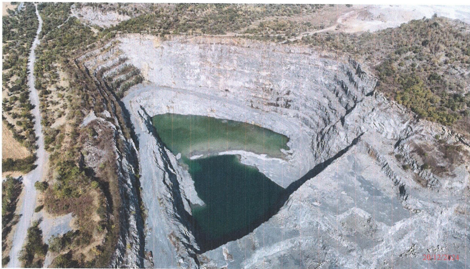
ภาพ ที่ 9 : บ่อพักน้ำคักตะกอนบริเวณที่พื้นที่ต่ำสุดของหน้าเหมืองภายในพื้นที่โครงการ
