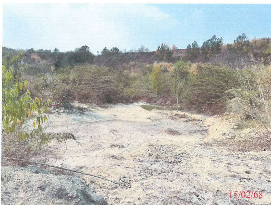
ภาพที่ ๕: บ่อดักตะกอนบริเวณที่ต่ำของหน้าเหมือง เพื่อพักน้ำก่อนระบายออกนอกพื้นที่ประทานบัตร
