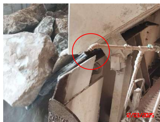
ระบบสเปรย์น้ำบริเวณที่ก่อให้เกิดฝุ่นละออง
