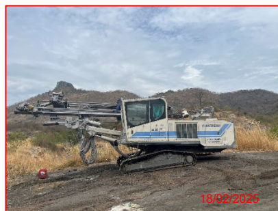
(8) รถเจาะรูระเบิด พร้อมติดอุปกรณ์เก็บ ฝุ่น
