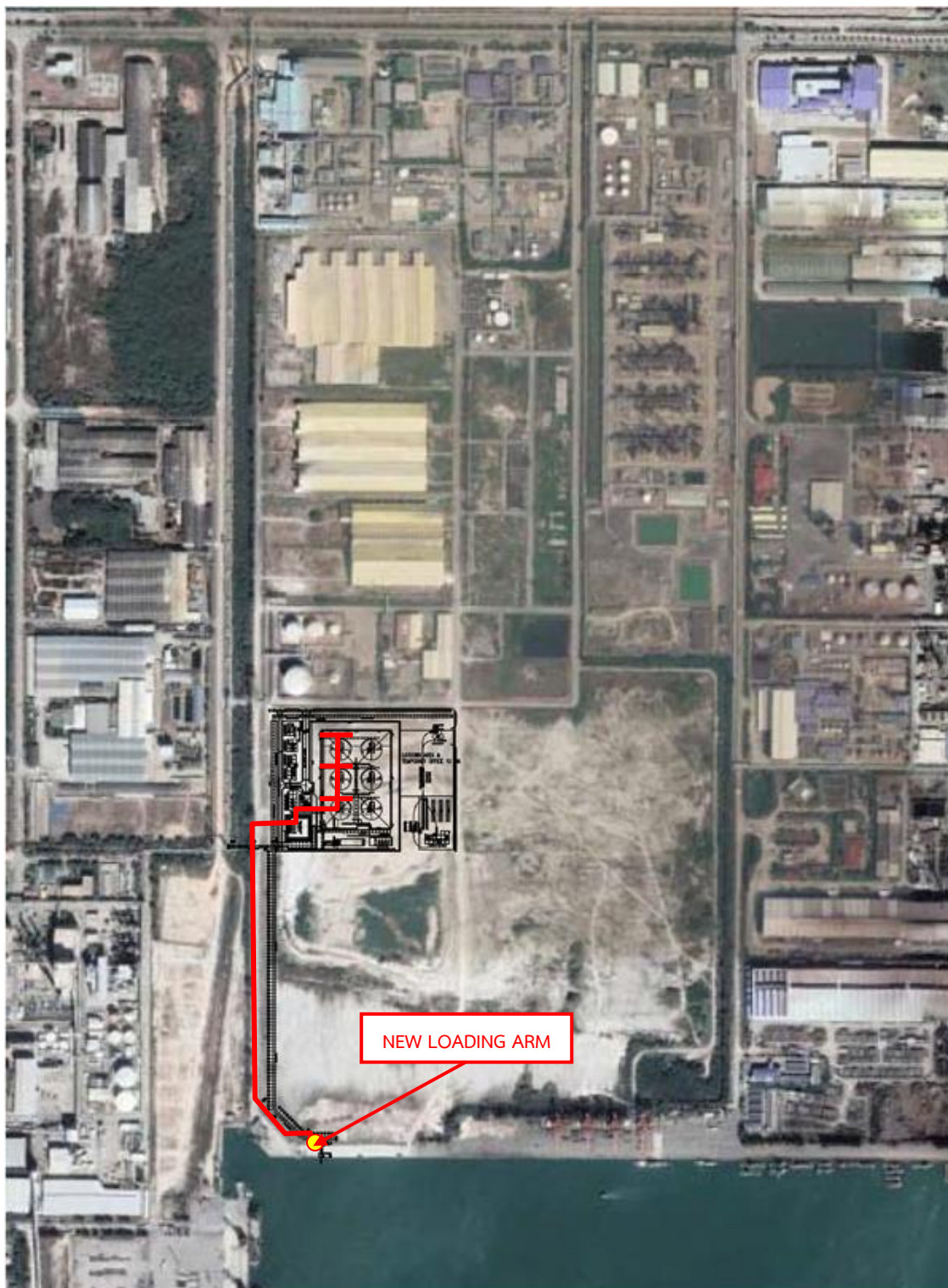
รูปที่ 1-2 ผังแสดงตำแหน่งการติดตั้ง Loading Arm และแนวเส้นทางวางท่อส่งผลิตภัณฑ์จาก ท่าเรือของบริษัท เอ็นเอฟซีที จำกัด (มหาชน) ไปยังถังเก็บผลิตภัณฑ์ (Tank Farm) บริษัท เอ็นเอฟซีที จำกัด
