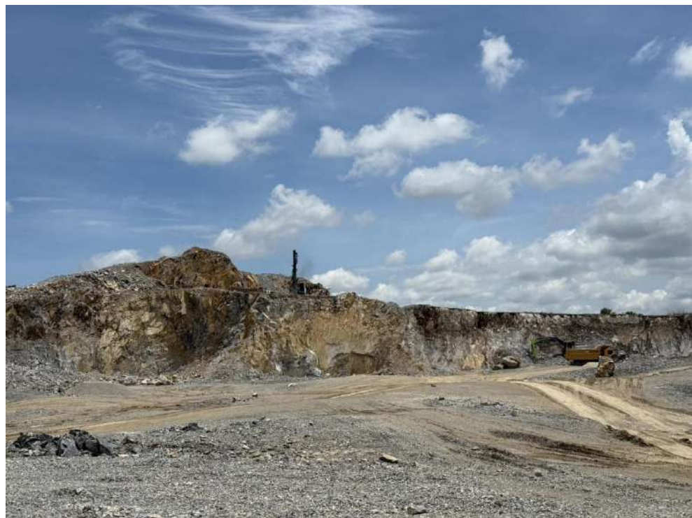
หน้างานการเจาะหลุมเจาะ หน้างานโล่งไม่มีหินก้อนใหญ่กีดขวางพร้อมสำหรับการทำระเบิด
