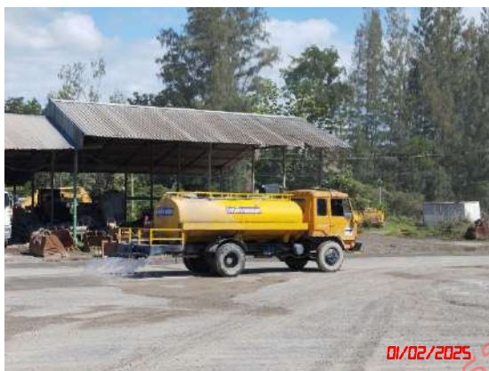
รูปที่ 19 การฉีดพรมน้ำบริเวณเส้นทางขนส่งแร่
