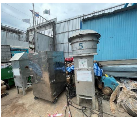
รูปที่ 3.2 การเก็บตัวอย่างคุณภาพอากาศในบรรยากาศ จุดที่ 1 บริเวณพื้นที่ก่อสร้าง ด้านที่อยู่ใกล้อาคารข้างเคียงมากที่สุด
