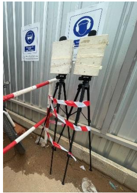
รูปที่ 3.23 การตรวจวัดระดับเสียงโดยทั่วไป และระดับเสียงรบกวน บริเวณพื้นที่ก่อสร้าง ด้านที่อยู่ใกล้อาคารข้างเคียงมากที่สุด
