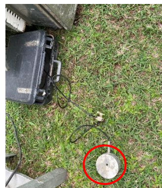
รูปที่ 3.59 การตรวจวัดความสั่นสะเทือน
