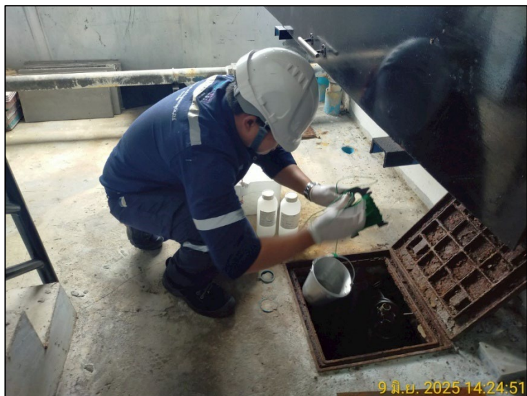
รูปที่ 3.3 การเก็บตัวอย่างน้ำทิ้ง
