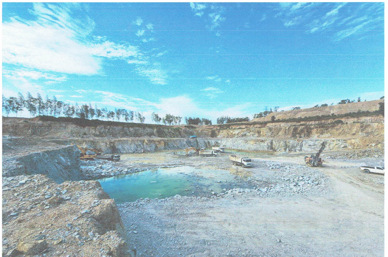
รูปที่ 1 แสดงพื้นที่การทำเหมืองลักษณะการทำเหมืองแบบชันบันได
