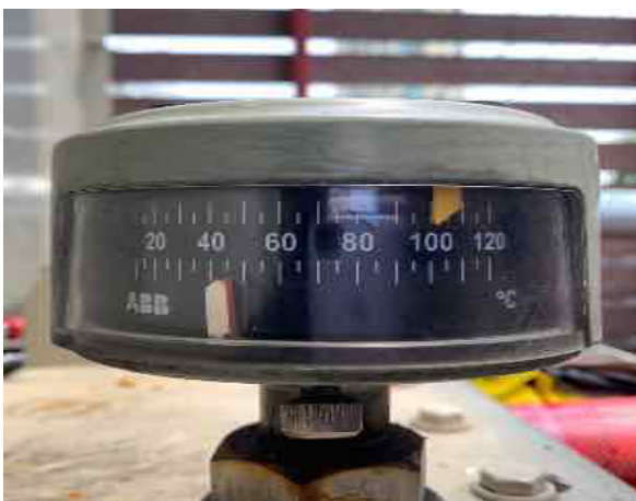
เทอร์โมมิเตอร์วัดอุณหภูมิของน้ำมัน : Oil Temp
