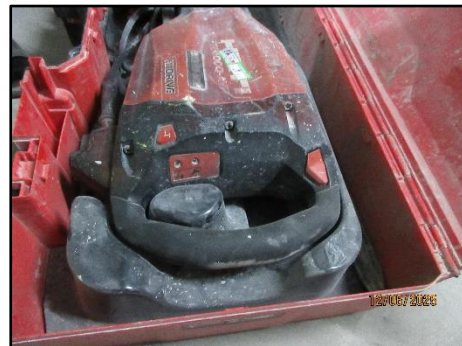
รูปที่ 90 วัสดุป้องกันการสั่นสะเทือนรองไว้ใต้เครื่องจักร รูปที่ 91 วัสดุป้องกันและดูดซับการสั่นสะเทือน หุ้มด้ามเครื่องมือ
