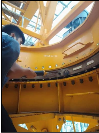
รูปที่ 25 การหยอดน้ำมันหล่อลื่นกับเครื่องจักร
