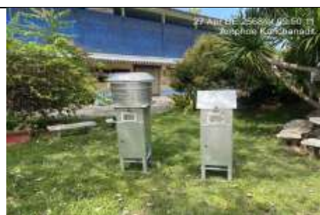
รูป AE ตรวจวัดปริมาณฝุ่นละอองรวม (TSP) และปริมาณฝุ่นละอองขนาดเล็กไม่เกิน 10 ไมครอน (PM10) จำนวน 3 สถานี
