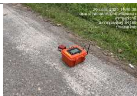
รูป AG ตรวจวัดแรงสั่นสะเทือน และแรงอัดอากาศจากการทำเหมือง จำนวน 2 สถานี
