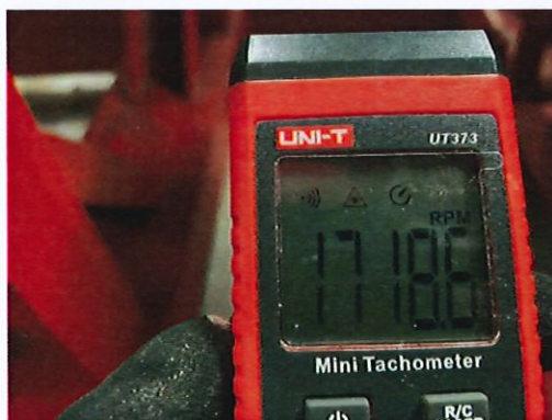
ความเร็วรอบเครื่องสูบน้ำดับเพลิง 1800 rpm
