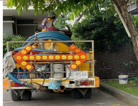
รูปที่ 2-7 การตัดไขมันจากบ่อดักไขมันเพื่อนำไปกำจัด
