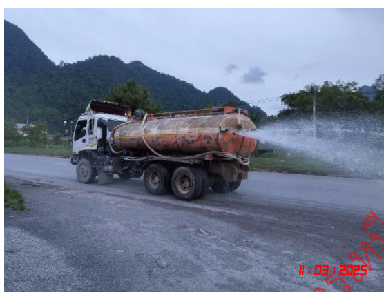
รูปที่ 14 ระบบป้องกันผลกระทบสิ่งแวดล้อมบริเวณโรงโม่บด และย่อยหิน
