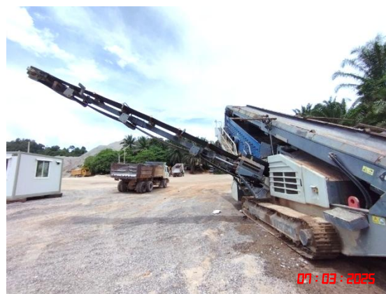
รูปที่ 24 เครื่องจักรอุปกรณ์ในการบด ย่อยหินแบบเคลื่อนที่ (Mobile Machine)
