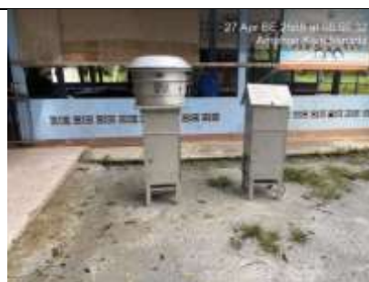
รูป V : ตรวจวัดปริมาณฝุ่นละอองแขวนลอยในบรรยากาศเฉลี่ยในรอบ 24 ชั่วโมงเป็นเวลา 3 วันต่อเนื่อง โดยใช้เครื่อง High Volume Air Sampler จำนวน 2 สถานี
