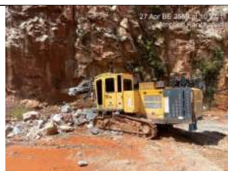
รูป V : มีการใช้เครื่องเจาะรูระเบิดแบบ Hydraulic Crawler Drill
