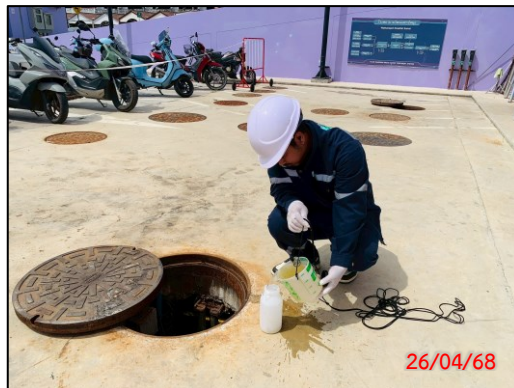
น้ำเสียก่อนเข้าสู่ระบบบำบัดน้ำเสีย (บ่อปรับสมดุล)
