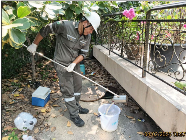
รูปที่ 3-4 การเก็บตัวอย่างน้ำทิ้งจุดที่ 4 บริเวณบ่อพักน้ำใสหลังจากจากระบบบำบัดน้ำเสีย (อาคาร B)
