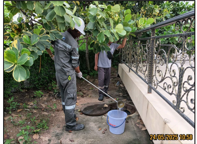
รูปที่ 3-4 การเก็บตัวอย่างน้ำทิ้งจุดที่ 4 บริเวณบ่อพักน้ำใสหลังจากจากระบบบำบัดน้ำเสีย (อาคาร B)
