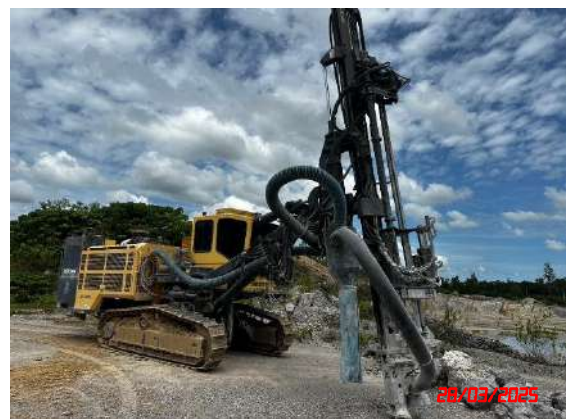
รูปที่ 26 เครื่องเจาะรูระเบิดที่ติดตั้งอุปกรณ์เก็บฝุ่นไว้บริเวณหัวเจาะ
