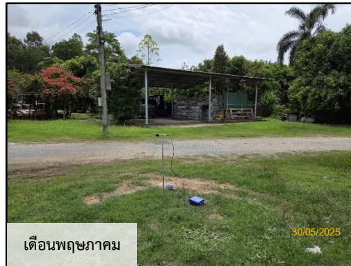
ภาพที่ 3.9 การตรวจวัดความสั่นสะเทือนจากการระเบิดหิน บริเวณชุมชนบ้านชะอมตะวันออก
