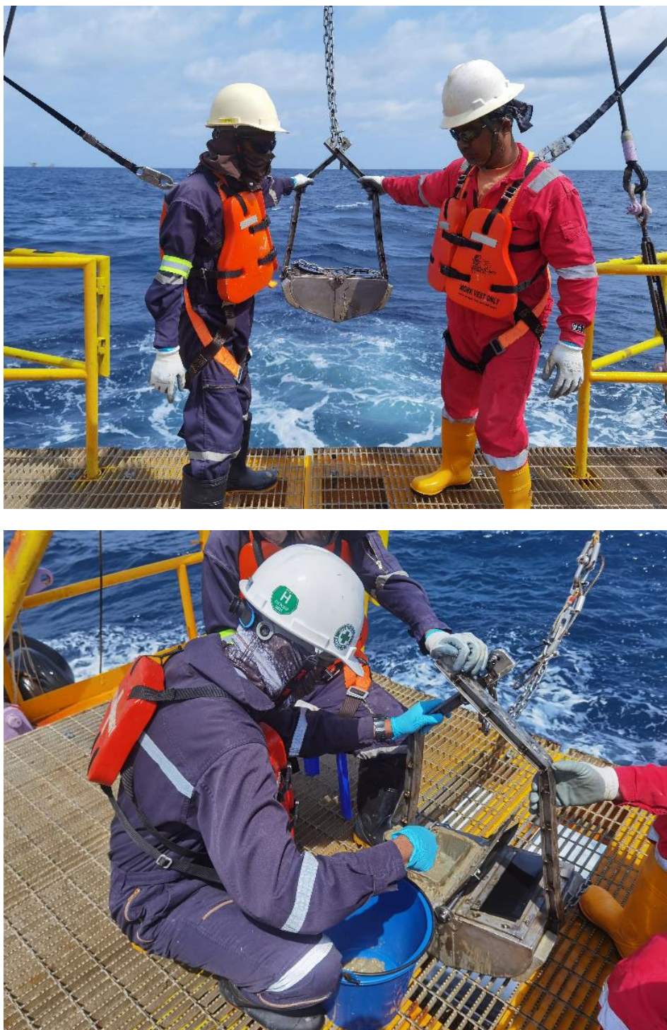
รูปที่ 4-166 การเก็บตัวอย่างตะกอนพื้นทะเล (บน) การวัดความหนาของชั้นเศษหินบนพื้นทะเล (ล่าง)
