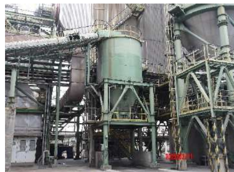
ภาพที่ 2.2-31 ไซโลหรือ Collecting Pit เก็บเถ้าหนักแบบปิด
