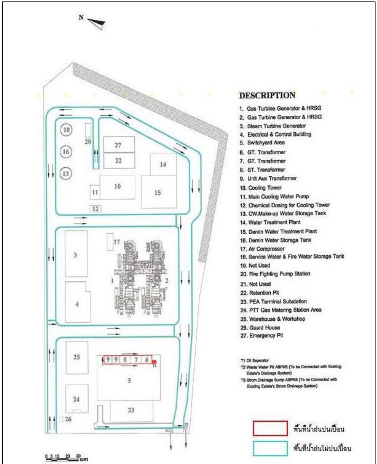
ภาพที่ 1.4 ผังแสดงระบบระบายน้ำของโครงการ
