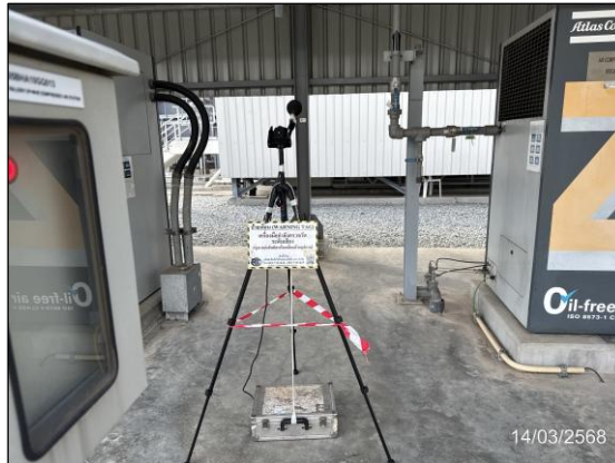
รูปที่ 3.15 การตรวจวัดระดับเสียงในพื้นที่การทำงาน 8 ชั่วโมง 7 วันต่อเนื่อง บริเวณเครื่องอัดอากาศ
