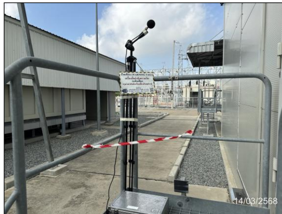
รูปที่ 3.16 การตรวจวัดระดับเสียงในพื้นที่ทำงาน บริเวณเครื่องผลิตไฟฟ้ากังหันก๊าซ
