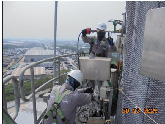
รูปที่ 3.1 การเก็บตัวอย่างคุณภาพอากาศในปล่องระบาย บริเวณ ปล่องหน่วยผลิตไอน้ำ HRSG 51
