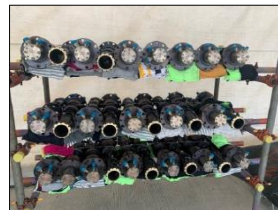
รูปที่ 2.4 อุปกรณ์ Burner ในระบบหัวฉีดเผาไหม้ แบบ Dry Low NO x
