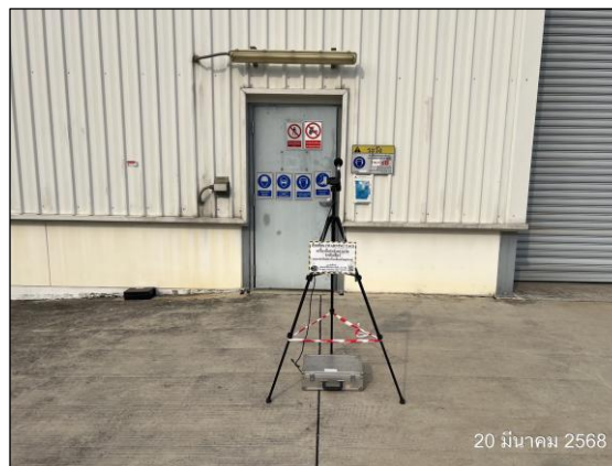
รูปที่ 3.11 การตรวจวัดระดับเสียงในพื้นที่ทำงาน บริเวณเครื่องผลิตไฟฟ้ากังหันไอน้ำ
