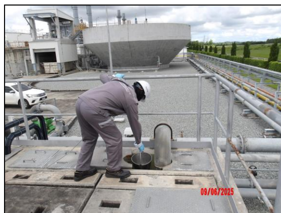
รูปที่ 3.13 การเก็บตัวอย่างคุณภาพน้ำทิ้ง บริเวณ บ่อตรวจสอบคุณภาพน้ำทิ้ง
