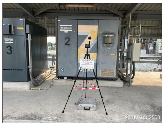
รูปที่ 3.12 การตรวจวัดระดับเสียงในพื้นที่ทำงาน บริเวณเครื่องอัดอากาศ
