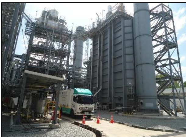
ภาพที่ 1 แสดงการตรวจวัดเพื่อทดสอบความแม่นยำสัมพัทธ์ ระบบ CEMS สำหรับตรวจวัดก๊าซ ของบริเวณ ปล่องหน่วยผลิตไอน้ำ HRSG# 41
