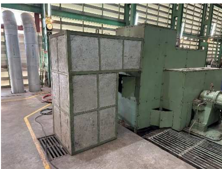
ภาพที่ 2.2-23 อุปกรณ์ปิดครอบเครื่องจักรที่มีเสียงดัง
