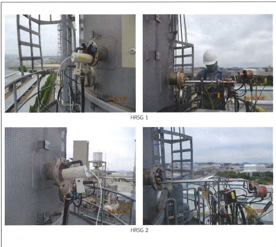
ภาพที่ 3.4-1 แสดงการตรวจวัดคุณภาพอากาศจากปล่องระบายนสาร
