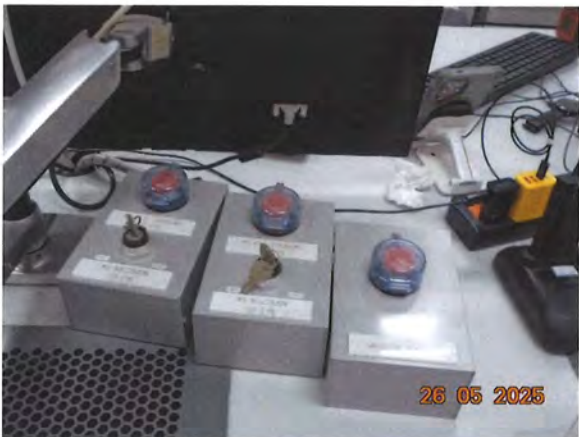
ภาพที่ 2.2-38 Emergency Switch
