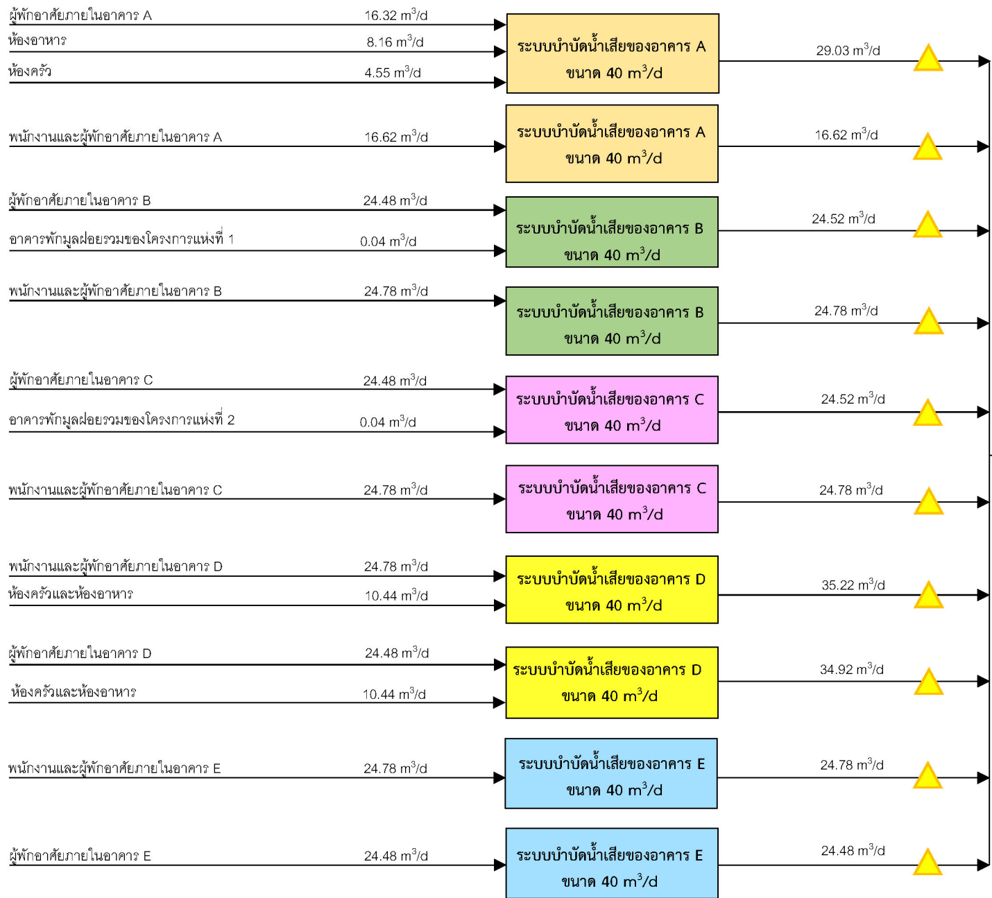
รูปที่ 2.2.3-1 ผังการจัดการน้ำเสียในภาพรวมของโครงการ
