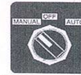
สวิทช์เลือกระบบการทำงาน MANUAL-OFF-AUTO
