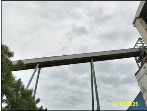
รูปที่ 2-7 ระบบสายพานลำเลียงเชื้อเพลิงชีวมวล
