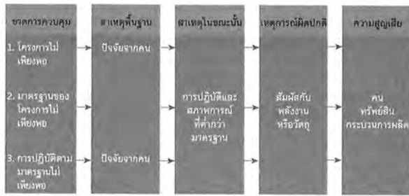
รูปที่ 3 แบบจำลองเกี่ยวกับการค้นหาสาเหตุของอุบัติเหตุและความสูญเสีย (Loss Causation Model)
