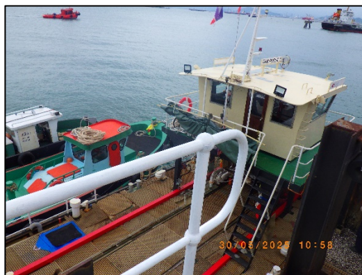
รูปที่ 2.7 เรือกำจัดคราบน้ำมัน สำหรับกำจัดคราบน้ำมันที่รั่วไหล
