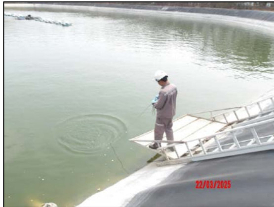
รูปที่ 3.2 การเก็บตัวอย่างคุณภาพน้ำทิ้ง บริเวณ ป่อพักน้ำสำหรับดับเพลิง (ป่อพักน้ำทิ้งจากบ่อตกตะกอน)
