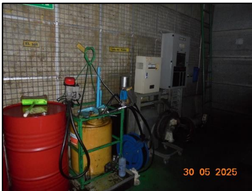
รูปที่ 13 ถังรองรับน้ำมันหล่อลื่นที่ใช้แล้ว
