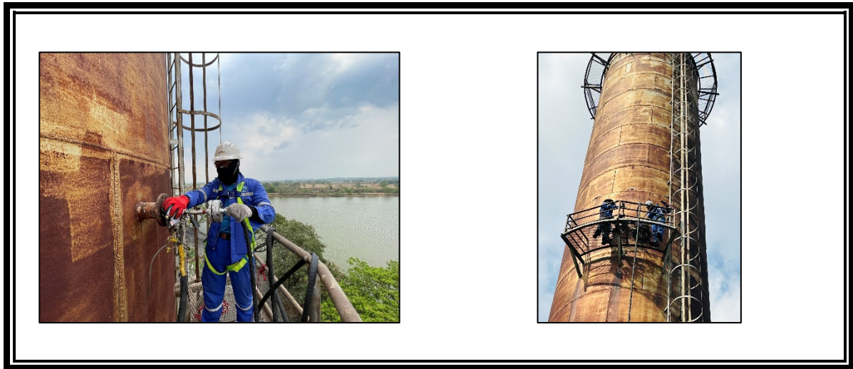
รูปที่ 3.3-1 จุดตรวจวัดคุณภาพอากาศจากปล่องปล่อยทิ้งอากาศเสีย บริเวณหม้อไอน้ำ ชุดที่ 1
