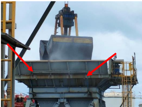
ภาพที่ 2-3 การฉีดพรมน้ำในระหว่างขนถ่าย ถ่านหินจากเรือลงบนฮอปเปอร์รับถ่านหิน
