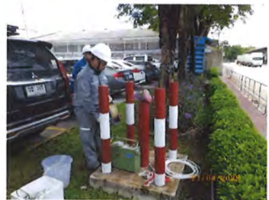
ภาพที่ 2-5 บ่อตรวจวัดคุณภาพน้ำใต้ดินของพื้นที่ TPE Site1
