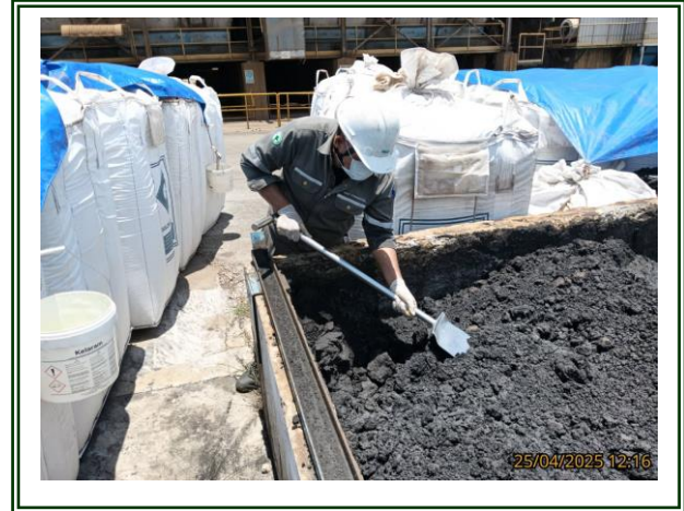
รูปที่ 4-56 เก็บตัวอย่างกากของเสีย Sludge Drying Bed เก็บตัวอย่างในวันที่ 25 เมษายน 2568
