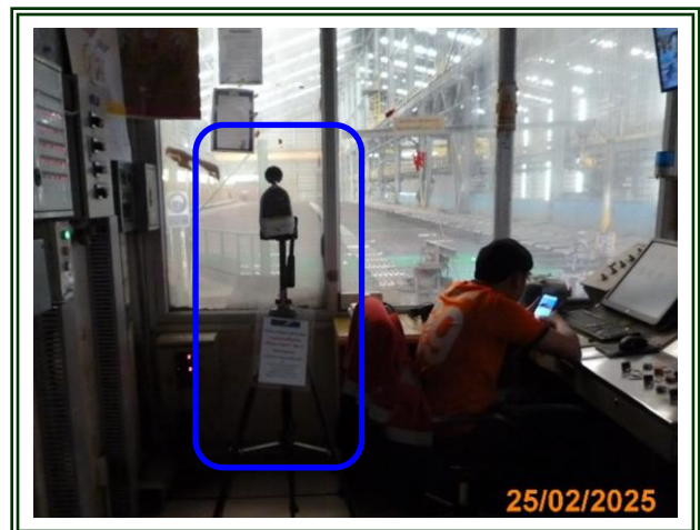
รูปที่ 4-84 ตรวจวัดระดับเสียงในพื้นที่การทำงาน บริเวณ Pendulum Shear (ห้องควบคุม) ตรวจวัดในวันที่ 25 กุมภาพันธ์ 2568
