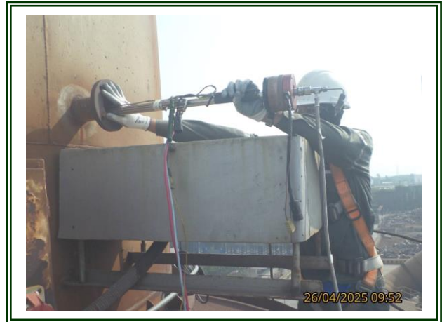
รูปที่ 4-44 ตรวจวัดปล่องที่ผ่านโรงกำจัดฝุ่น (Fume Plant # 1) ตรวจวัดในวันที่ 26 เมษายน 2568
