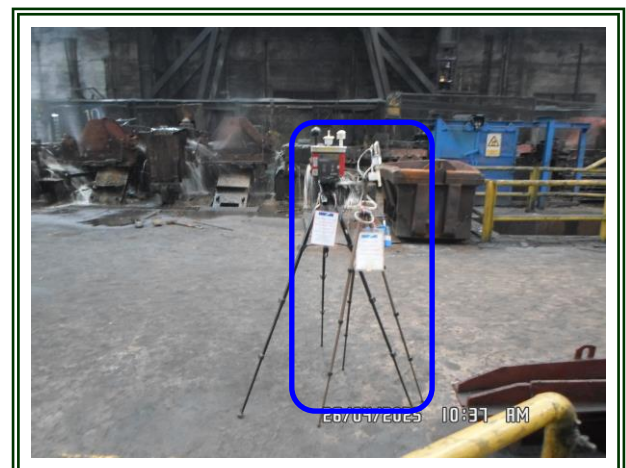
รูปที่ 4-58 ตรวจวัดฝุ่นละอองบริเวณแท่นรีดเหล็ก เก็บตัวอย่างในวันที่ 26 เมษายน 2568
