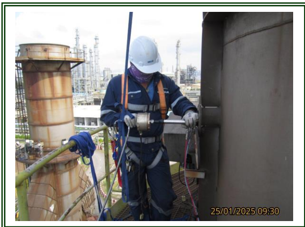
รูปที่ 4-45 ตรวจวัดปล่องที่ผ่านโรงกำจัดฝุ่น (Fume Plant # 2) ตรวจวัดในวันที่ 25 มกราคม 2568
