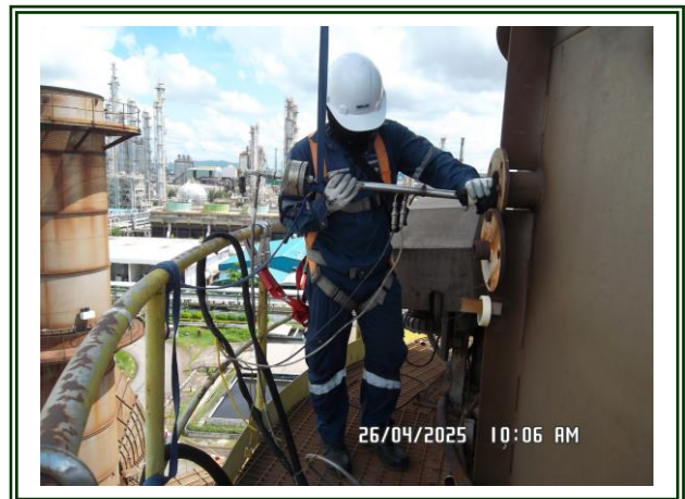
รูปที่ 4-46 ตรวจวัดปล่องที่ผ่านโรงกำจัดฝุ่น (Fume Plant # 2) ตรวจวัดในวันที่ 26 เมษายน 2568
