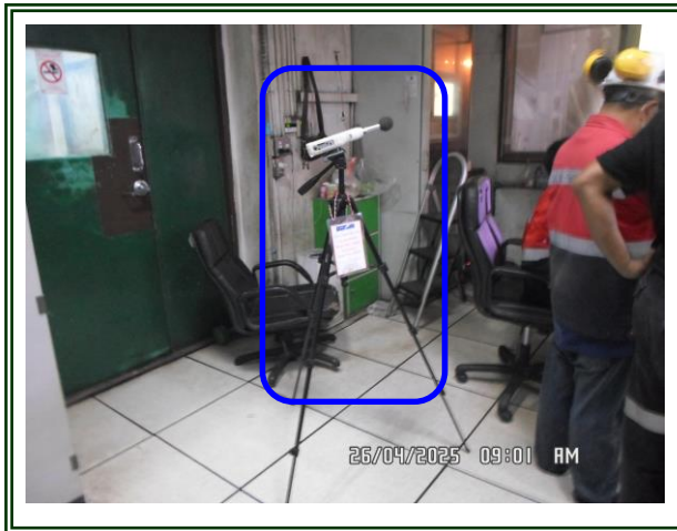
รูปที่ 4-85 ตรวจวัดระดับเสียงในพื้นที่การทำงาน บริเวณเตาหลอมเหล็ก EAF (ห้องควบคุม) ตรวจวัดในวันที่ 26 เมษายน 2568
