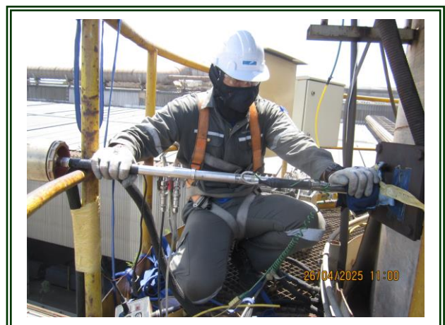
รูปที่ 4-48 ตรวจวัดปล่องของเตาอบเหล็กแท่ง (RHF) ตรวจวัดในวันที่ 26 เมษายน 2568
