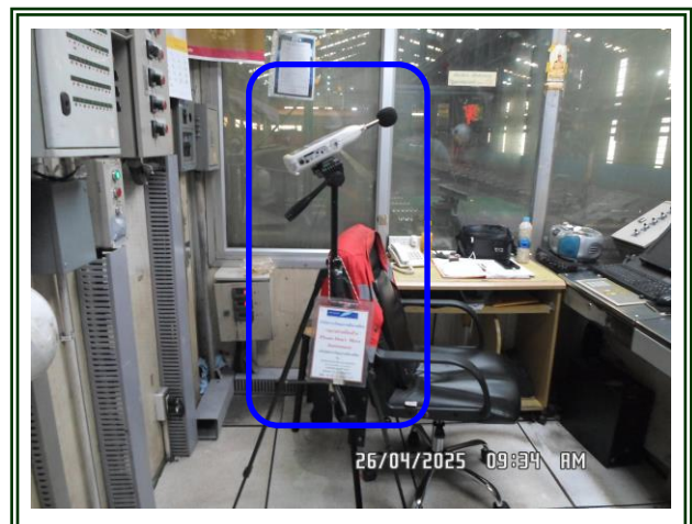
รูปที่ 4-88 ตรวจวัดระดับเสียงในพื้นที่การทำงาน บริเวณ Pendulum Shear (ห้องควบคุม) ตรวจวัดในวันที่ 26 เมษายน 2568
