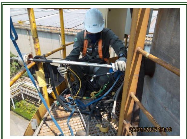
รูปที่ 4-47 ตรวจวัดปล่องของเตาอบเหล็กแท่ง (RHF) ตรวจวัดในวันที่ 25 มกราคม 2568
