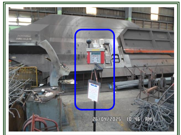
รูปที่ 4-66 ตรวจวัดระดับความร้อนบริเวณจุดผลิตเหล็กเส้นขึ้นรูป ตรวจวัดในวันที่ 26 เมษายน 2568
